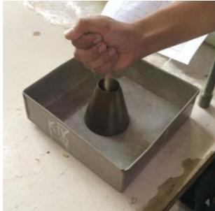
Gambar 1. Memasukkan benda uji ke cetakan kerucut
