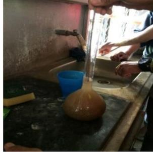
Gambar 4. Mengeluarkan udara dari *Pycnometer*
