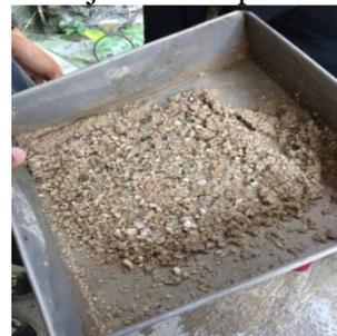
Gambar 7. Mengeluarkan benda uji dan memasukkan ke oven
