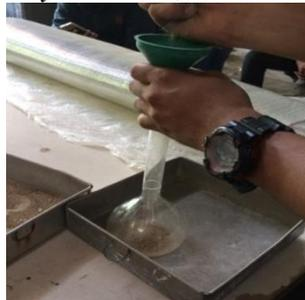
Gambar 3. Memasukkan benda uji ke *Pycnometer*
