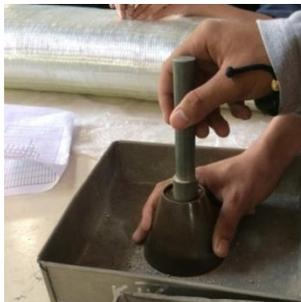
Gambar 2. Memadatkan benda uji dengan tongkat pemadat
