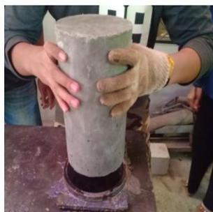
Gambar 2. Melakukan *capping* pada beton
