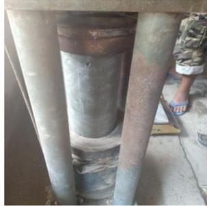
Gambar 3. Meletakkan beton pada CTM
