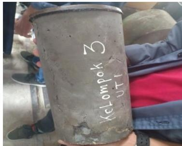
Gambar 5. Pola retak beton
